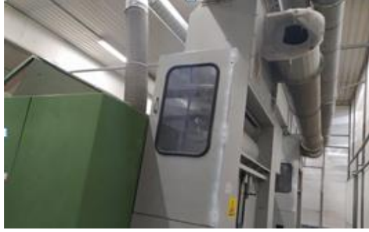
Sonra (Tarak makineleri dişliler kapatıldı)
