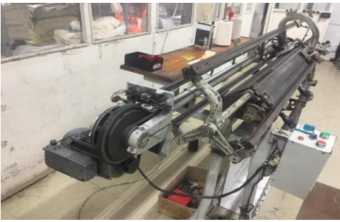
Önce (Örme makinesi döner aksamlar açıkta )
