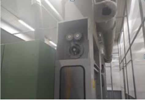
Önce (Tarak makineleri dişliler açık)
